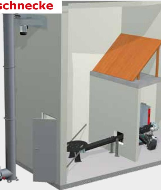
Die Fröling Senkrecht-Förderschnecke setzt neue Maßstäbe bei der Förderleistung (bis zu 40 m<sup>3</sup>/h), Betriebssicherheit und beim Verteilergebnis. Die Hackschnitzel werden vom Aufnahmetrog mit einer Schnecke in die Förderanlage geschoben, die den Brennstoff auf die gewünschte Höhe zur Verteil-Vorrichtung transportiert. Die Senkrecht-förderschnecke ermöglicht so eine staubarme Befüllung des Lagerraums und sorgt für eine gleichmäßige Verteilung des Brennstoffes.
