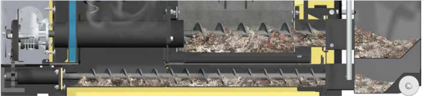
Die automatische Entaschung der Retorte und des Wärmetauschers in den Aschebehälter erfolgt mit zwei separaten Ascheschnecken, die über einen gemeinsamen Getriebemotor angetrieben werden.
