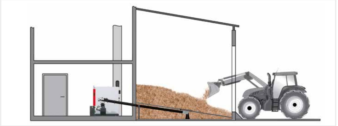
**Einbringung mit Bunker-Befüllschnecke**
