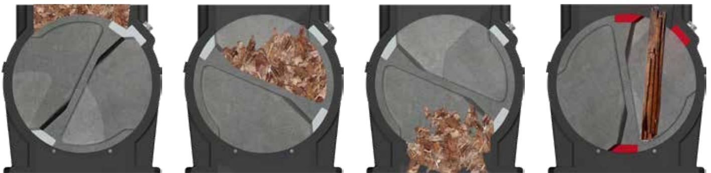
Die zwei großvolumigen Kammern (Tiefe je 180 mm) eignen sich hervorragend für die Aufnahme von Hackgut bis P31S (ehemals G50). Großer Widerstand wird automatisch erkannt. Die Zellradschleuse und Schnecke laufen rückwärts (je nach eingestellten Parametern mehrmals) bis ein Weitertransport möglich ist.
